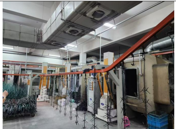
喷塑及固化流水线
